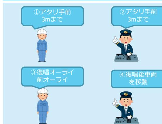
操車係の指示を復唱し、連結位置3m手前まで車両を移動させます。
