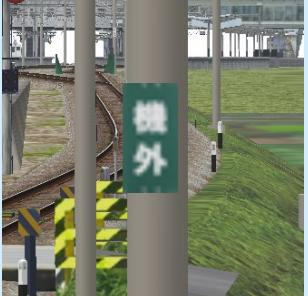
場内信号が停止現示などの理由で機外停車する場合この標識付近に停車します。 |
