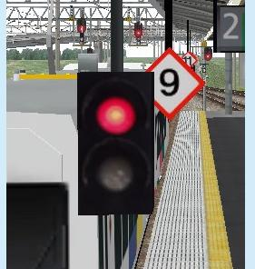
併合、分割または検査のため列車/車両の移動が禁止されていることを示します。 |
