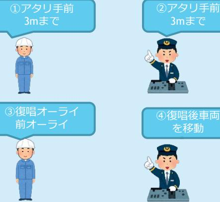
操車係の指示を復唱し、連結位置3m手前まで車両を移動させます。
