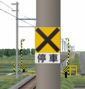
標識付近の駅に停車する場合、標識の位置で汽笛を吹鳴させます。 |
