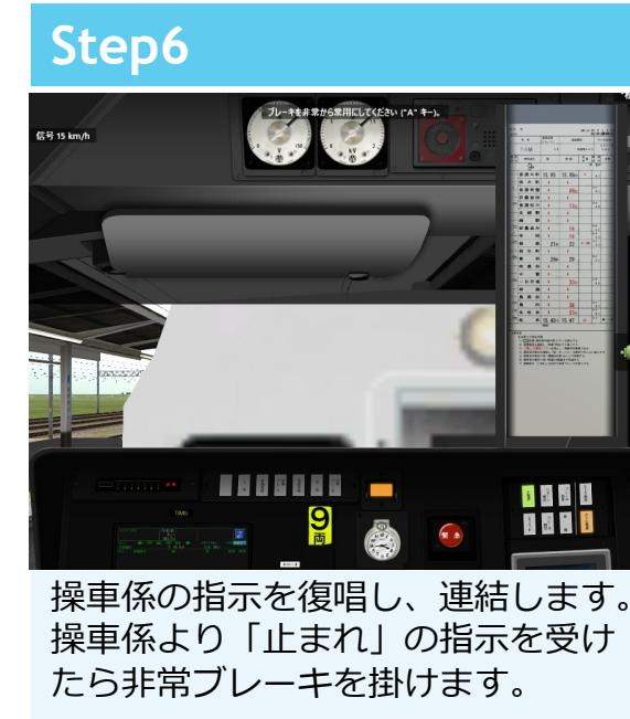
⚠ 連結時に出す速度は、BVEのガイダンスで1km/hから2km/h表示に変わるくらいが目安です。
