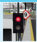
併合、分割または検査のた め列車/車両の移動が禁止
