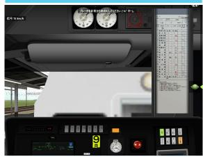
操車係の指示を復唱し、連結します。 操車係より「止まれ」の指示を受け たら非常ブレーキを掛けます。
