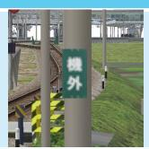
場内信号が停止現示などの 理由で機外停車する場合 この標識付近に停車します。 されていることを示します。 します。
