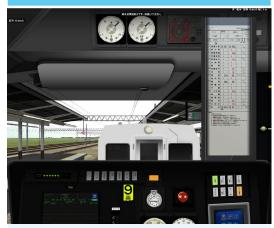
操車係の「止まれ」指示に従い、 連結位置3m手前±0.5mで停車さ せます。
